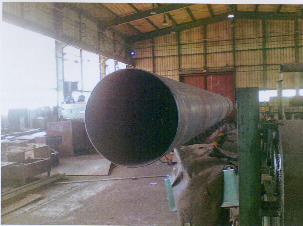
Proizvodnja čelične cevi velikog prečnika za potrebe fundiranja mosta
