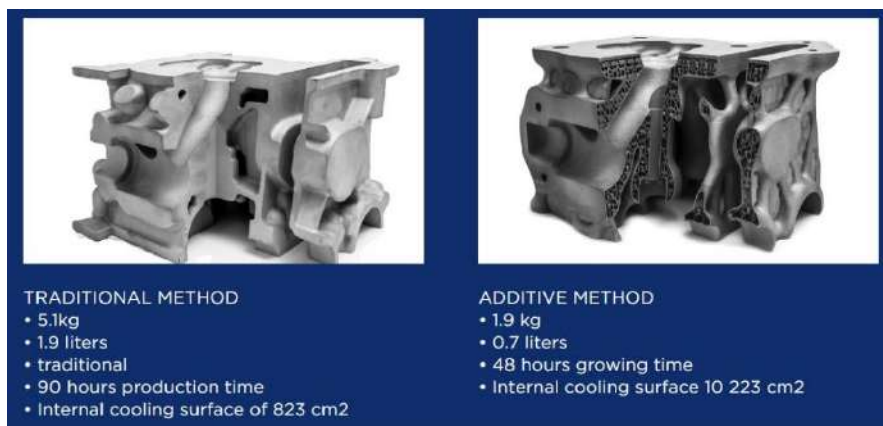
Slika 4: Poređenje karakteristika dva identična dela dobijena različitim metodama [37]
