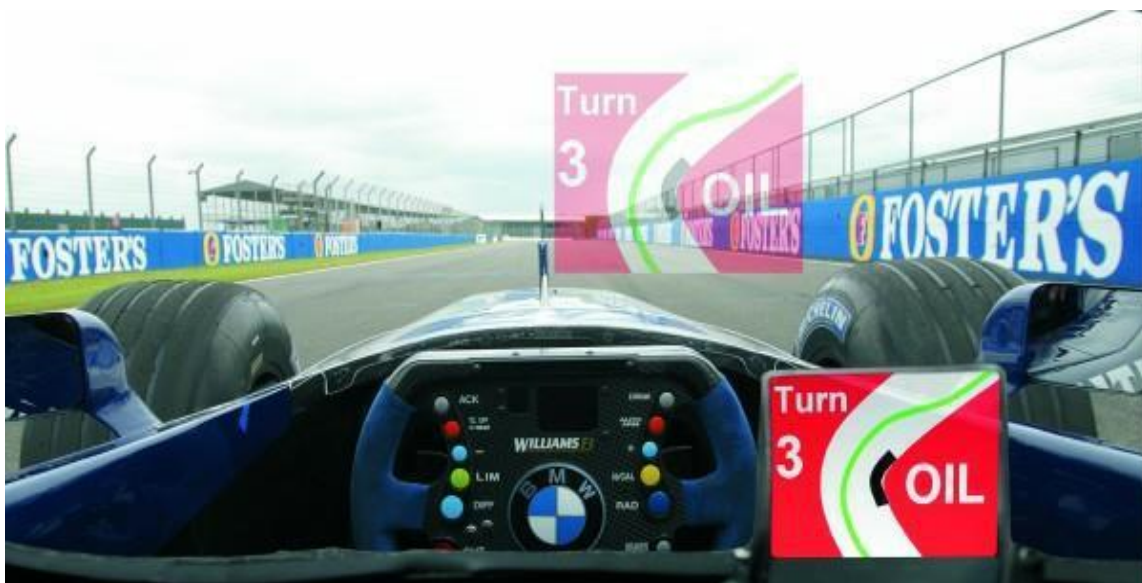
Slika 14. HUD pokazivač sa sistemom koji reaguje na pokrete glave, korišćen u formuli 1.
