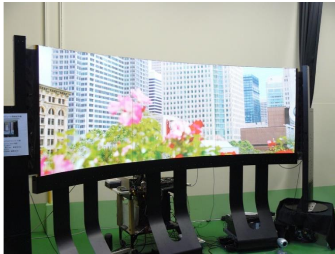
Slika 8. Zakrivljeni plazma displej veoma male debljine.
