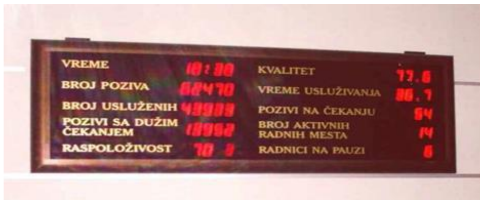
Slika 4. Primer elektronskog pokazivača velikog formata koji je pozicioniran na zidu radne prostorije za praćenje efikasnosti rada operatora u kol centru.
