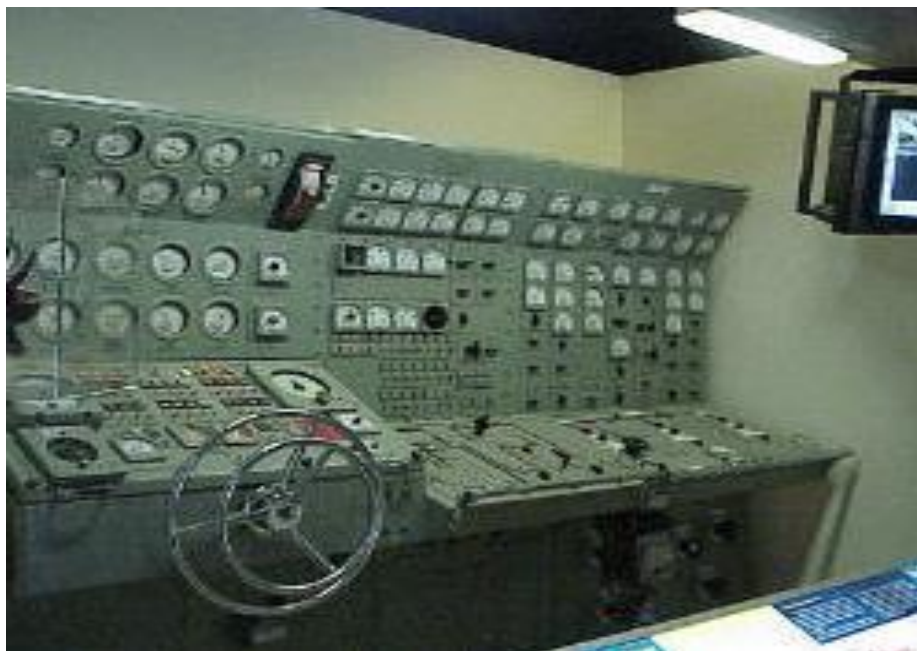
Slika 2. Konzola sa analognim pokazivačima u nuklearnoj podmornici.
