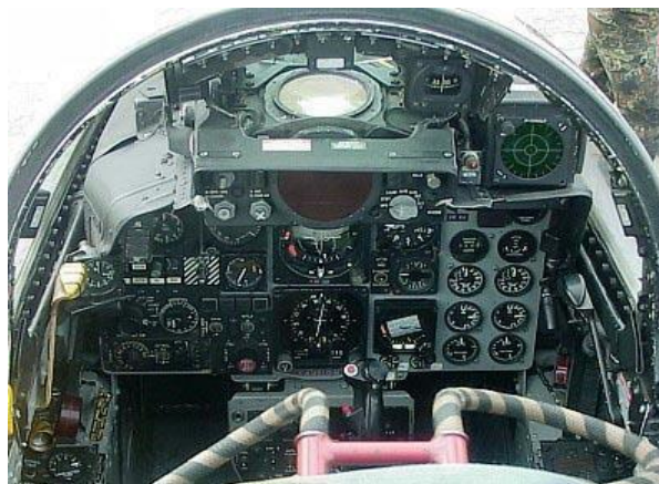
Slika 9. Kombinovana primena analognih i digitalnih pokazivača na primeru kokpita borbenog aviona F4.
