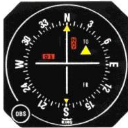
Slika 11. Primer devijacionog pokazivača koji se koristi za indikaciju devijacije kursa aviona.
