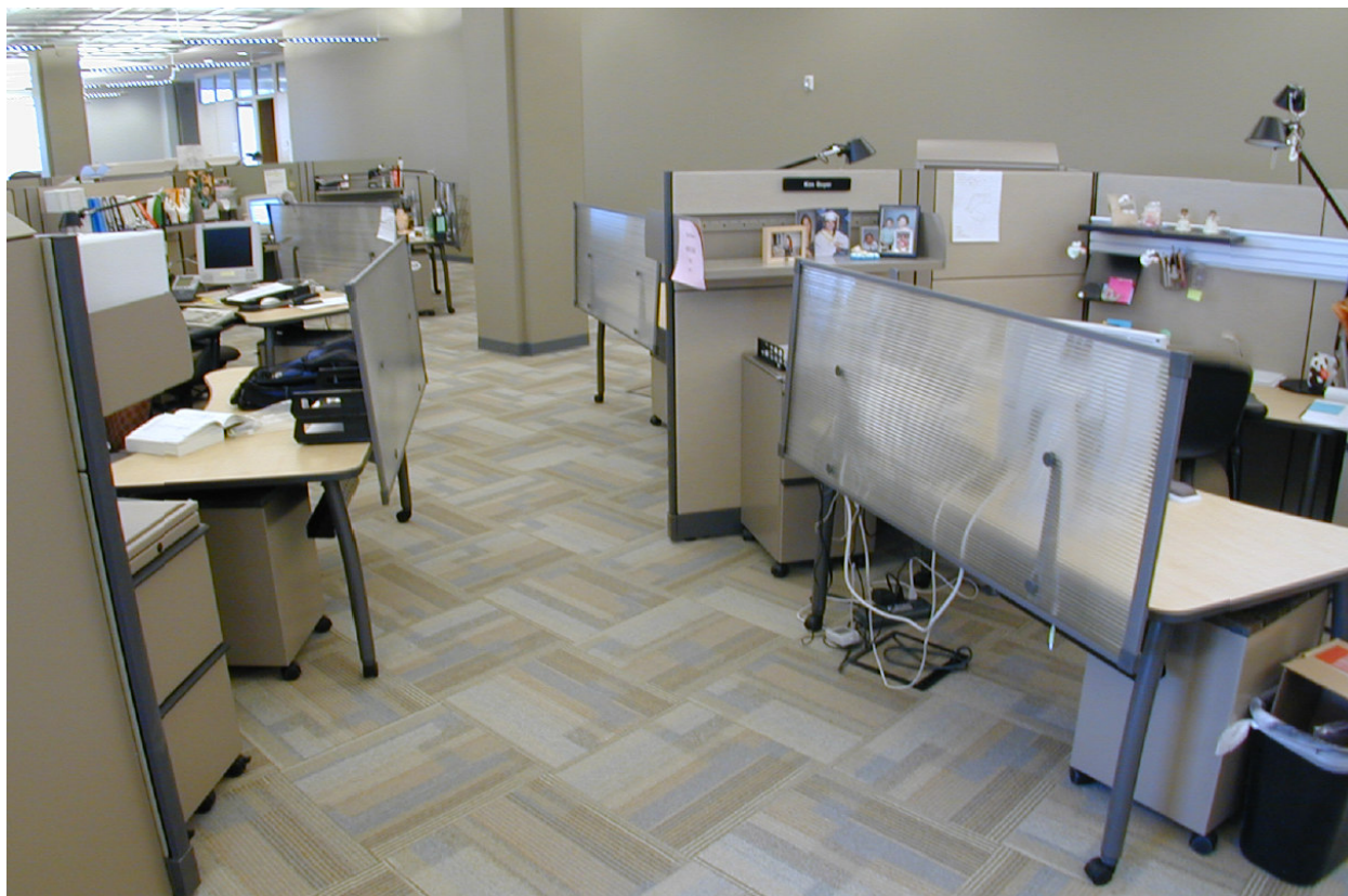
Slika 165. Korišćenje providnih, zvučno apsorbujućih pregrada prilikom dizajniranja radnih mesta (Rashid i saradnici).
