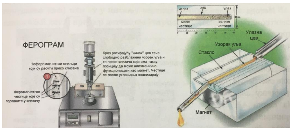
Slika X1. Princip detekcije magnetnih čestica ferografijom.
