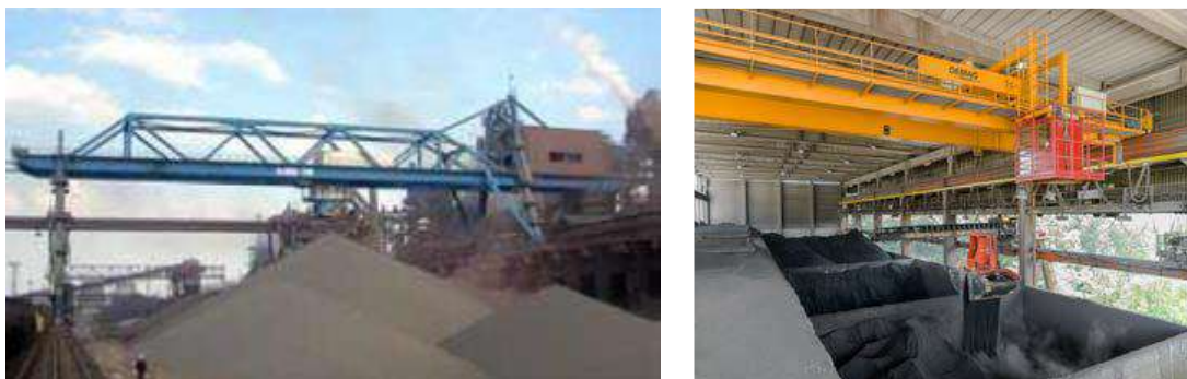
Slika IV-16. Podna skladišta za rasute materijale.
