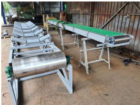
Slika III-4. Konstrukcija trakastih transporteta, ravna i profilisana traka.
